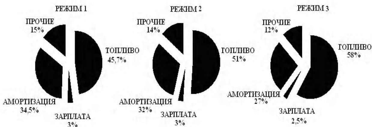
Рис. 3. Структуры себестоимости 1 кВтч по режимам: 1 – для 40,7 МВт, режим 2 – для 32 МВт, режим 3 – для 5,1 МВт мощности тепловой нагрузки
